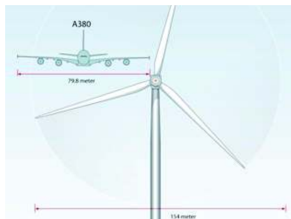
Diameter in dit voorbeeld 154 m; geplande turbines Nijverdal 136 m
