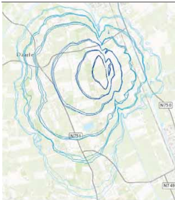
Figuur 1.8 Effect van een veranderend klimaat op de GVG-verlagingscontouren bij winlocatie Daarle
